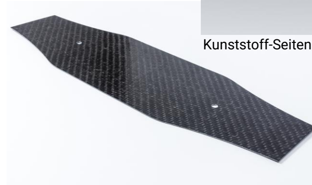
Organo-Einleger für Kunststoff Seitenaufprallträger (SLK, TU Chemnitz)
