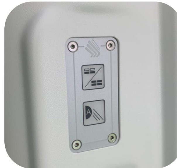
Abb. 2: Schalter in Differentialbauweise (AMB)
